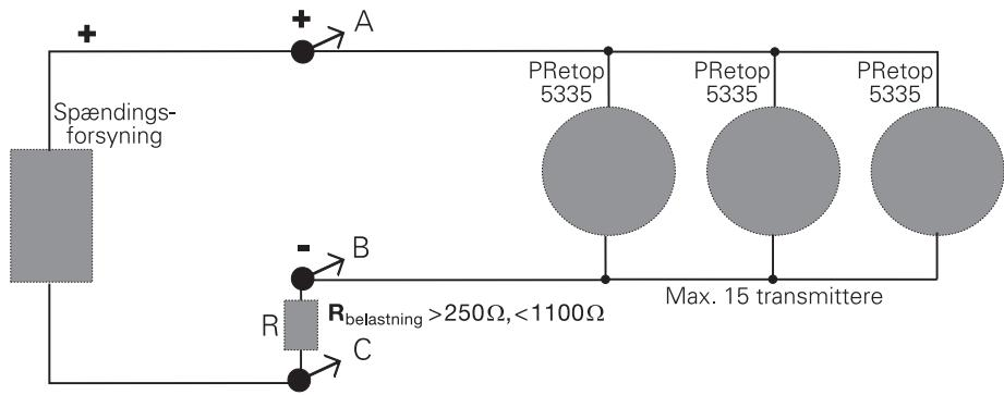
Udgangene på op til 15 transmittere kan parallelforbindes for digital HART®-kommunikation på 2-ledere.
