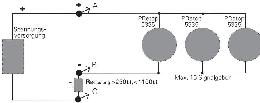
Im Ausgang können bis zu 15 Signalgeber für eine digitale Kommunikation über Zweileiter parallel geschaltet werden.
